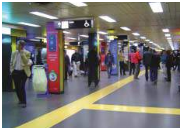
Señalización de los itinerarios principales mediante franjas guía de encaminamiento
