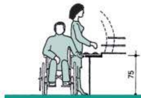
Dimensiones básicas de una barra de autoservicio
