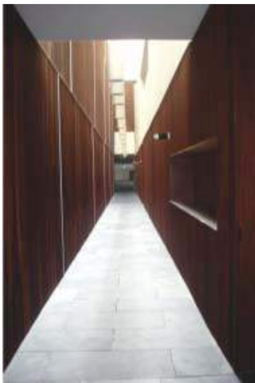
Ejemplo de buena practica en accesibilidad, paredes y suelo son de alto contraste cromático
