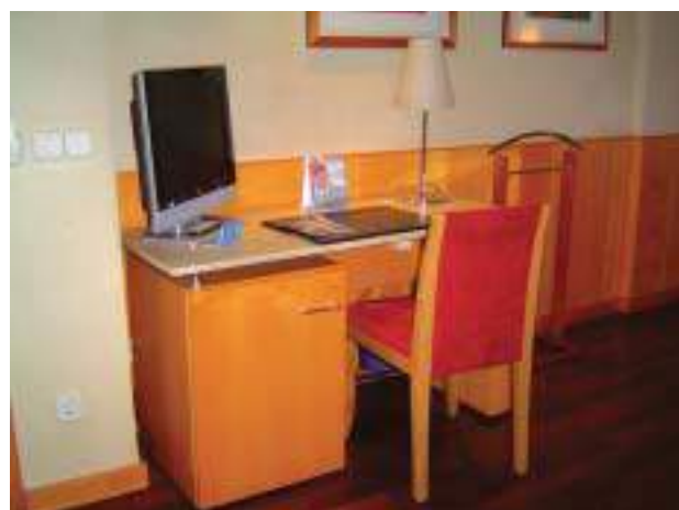
Una vez la silla retirada el escritorio permite la aproximación frontal de una persona en silla de ruedas
