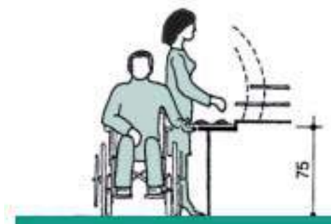
Dimensiones básicas de una barra de autoservicio para la aproximación lateral de una persona en silla de ruedas
