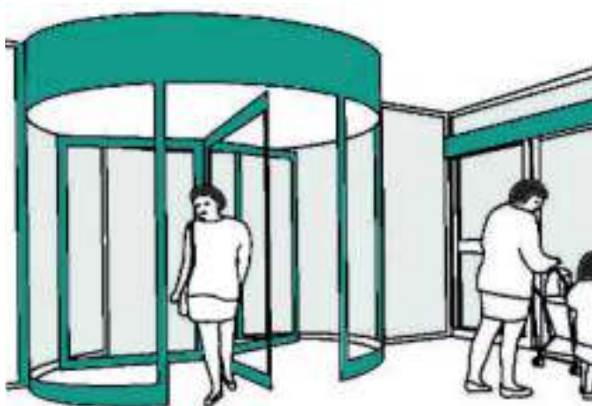
Puerta giratoria y puerta corredera alternativa.
